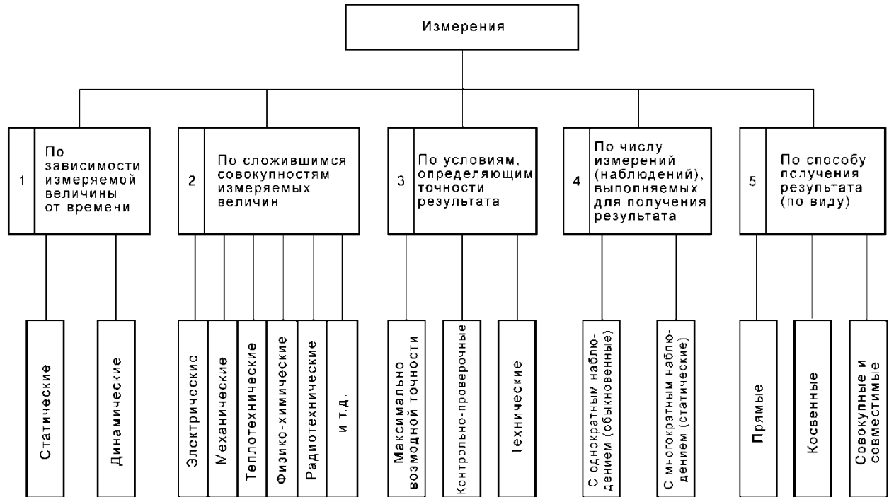
Рисунок 1 – Классификация средств измерения
