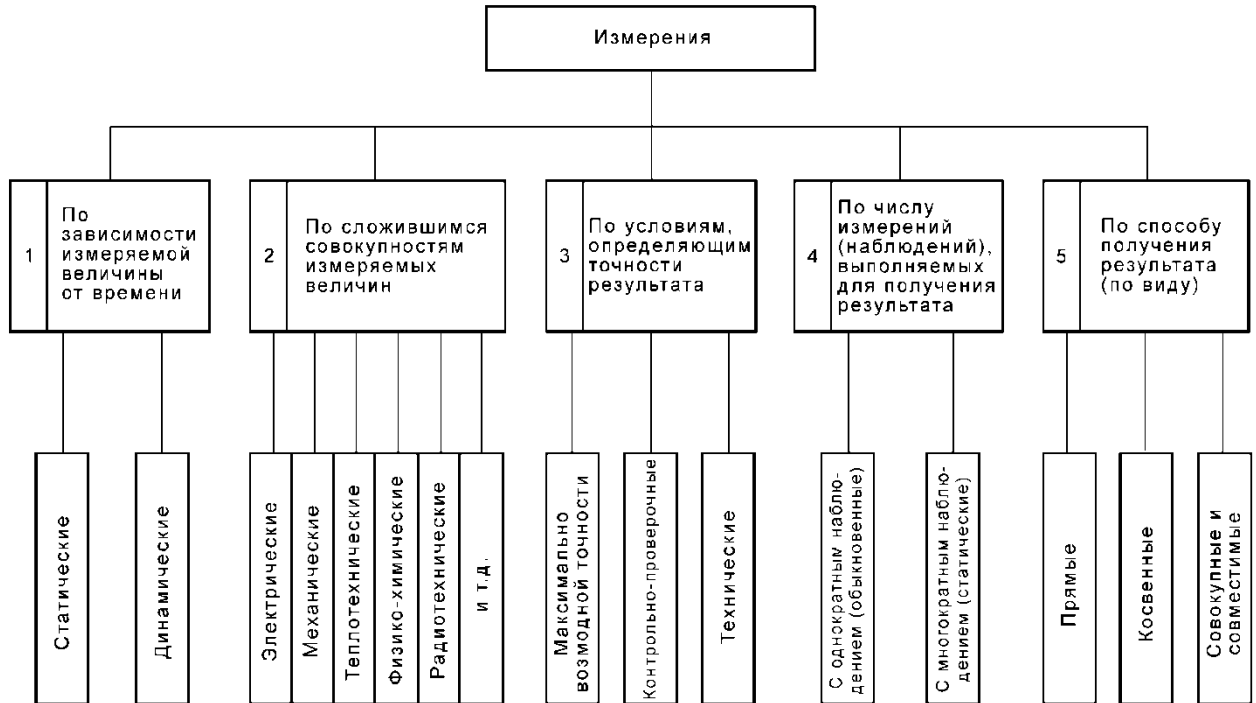
Рисунок 1 – Классификация средств измерения
